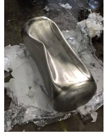
【試験による内槽の変形】
